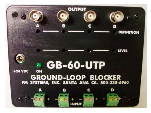
GROUND-LOOP BLOCKER FOR UNSHIELDED TWISTED PAIR WIRE
