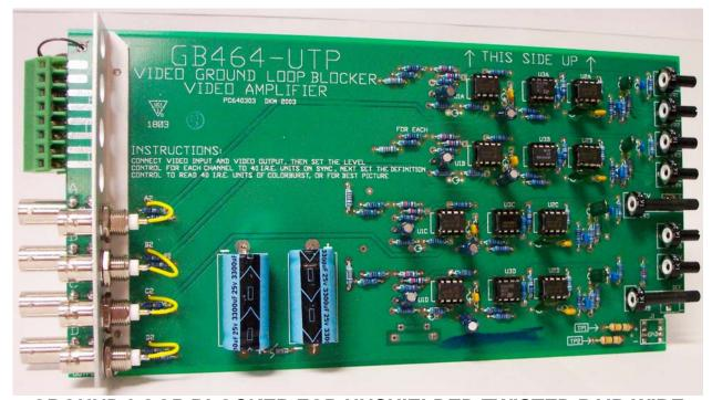
**GROUND-LOOP BLOCKER FOR UNSHIELDED TWISTED PAIR WIRE**
